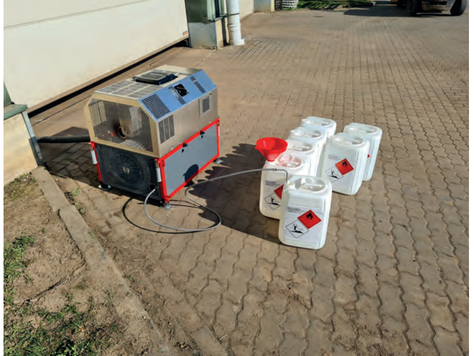
ARGOS-Anwendung mit dem Kaltvernebelungsgerät Mobilstar EK außerhalb des Lagers.
